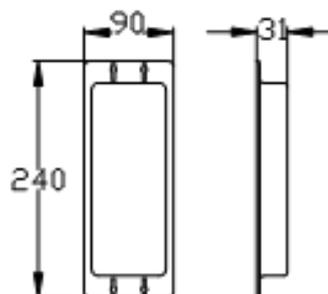
Antenne longue portée qui peut être ajoutée à l'émetteur au portail et aussi en option sur le moniteur de type mains libres. Une antenne peut amplifier la portée de 30%. Livré avec câble d'antenne de 2 mètres (RG174 avec connecteur mâle SMA).
